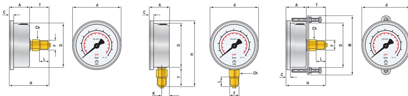
**Tipo F** montaggio da incasso con flangia, raccordo posteriore
